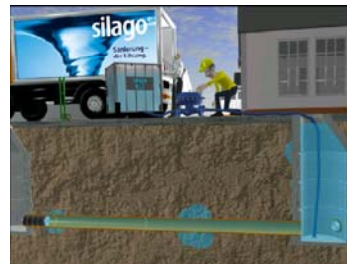
Bild 20: Verlustmessung und Injektion Komponente 1 (Quelle: SILAGO®)
