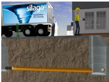
Bild 19: Befüllung des Leitungssystems mit Komponente 1 (Quelle: SILAGO®)
