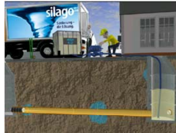
Bild 22: Befüllung des Leitungssystems mit Komponente 2 (Quelle: SILAGO®)
