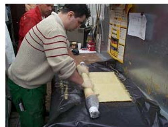
Bild 10: Fixierung Kurzliner auf Packer (Quelle: Fa. Rainer Kiel)
