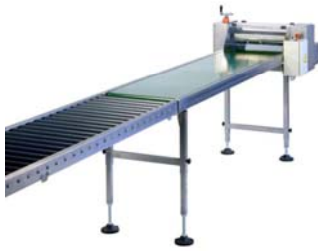
Bild 13: maschinelles Imprägnierband (Quelle: BRAWOLINER®)
